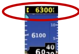
Figure 4 : Alerte visuelle si déviation de l'altitude cible
